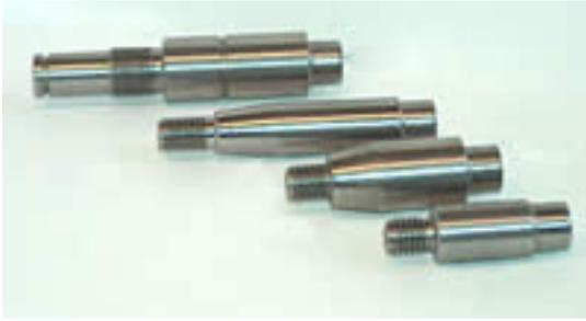
Abbildung 2: Übersicht über das Teilespektrum Schleifen
