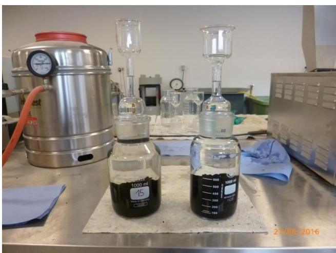
Rohdichtebestimmung des Mischgutes mit Bindemittel durch ein Pyknometer
