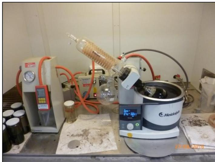
**Abbildung 22** Rückgewinnung des Bindemittels - Rotationverdampfer
