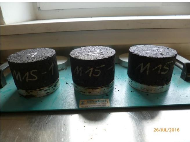
Ausgeformte und beschriftete Marshallprobekörper der ersten Versuchsreihe
