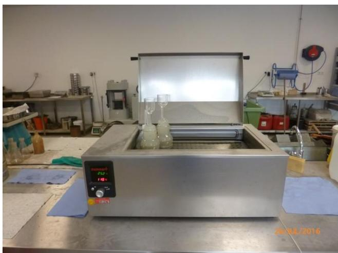
Rohdichtebestimmung des Gesteinskörnungsgemisches mit RA durch ein Pyknometer (Pyknometer befinden sich im Wärmebad, um Temperatur konstant zu halten)
