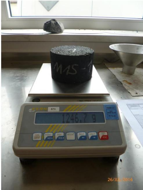
Ermittlung der Raumdichte des Asphaltprobekörpers durch Bestimmung der Masse der trockenen, sowie der feuchten Probe
