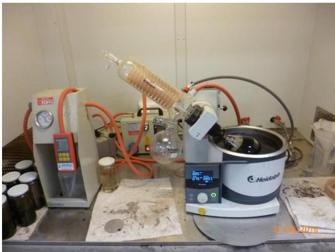
Destillation des Lösungsmittels Tri-
