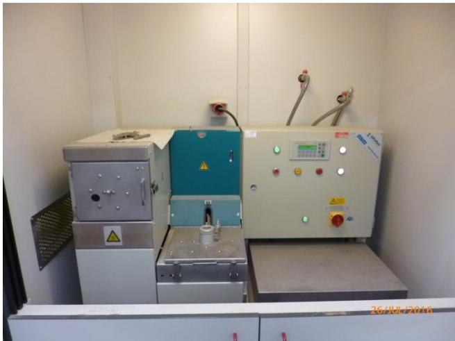
Bindemittlextraktion nach Zerkleinerung eines Marshall- Probekörpers
