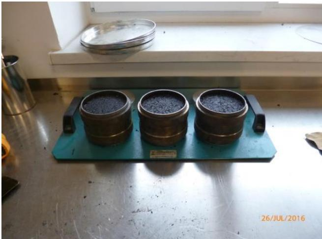
Abkühlung und anschließende Ausformung der Marshallprobekörper
