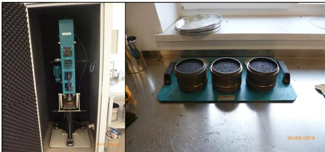
**Abbildung 29** MVG und Marshallprobekörper in Formzylindern
