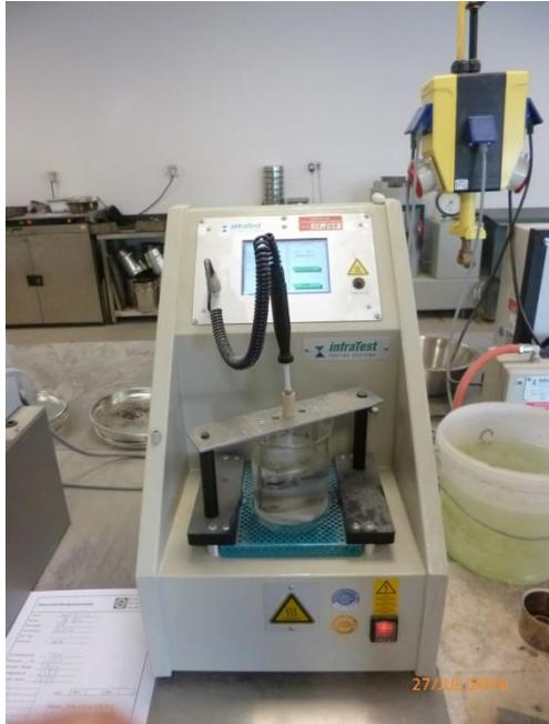
Ring und Kugel- Automat (Prüfgerät für EP RuK)
