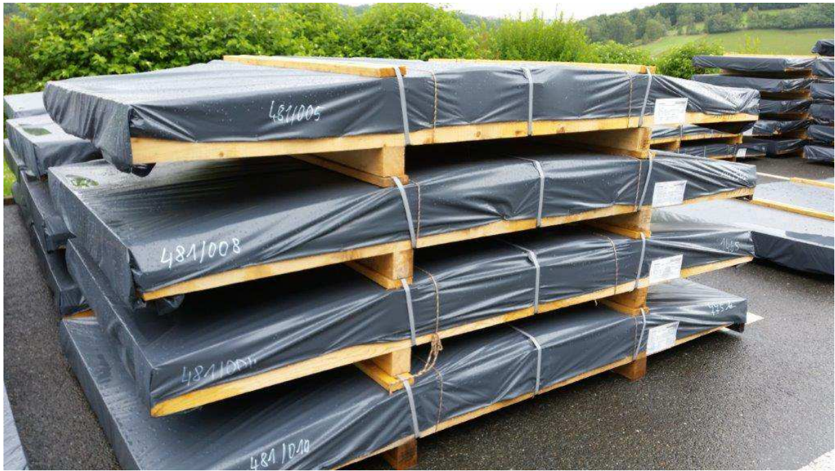
Transportfertige Silobleche (Quelle: Omeras GmbH)
