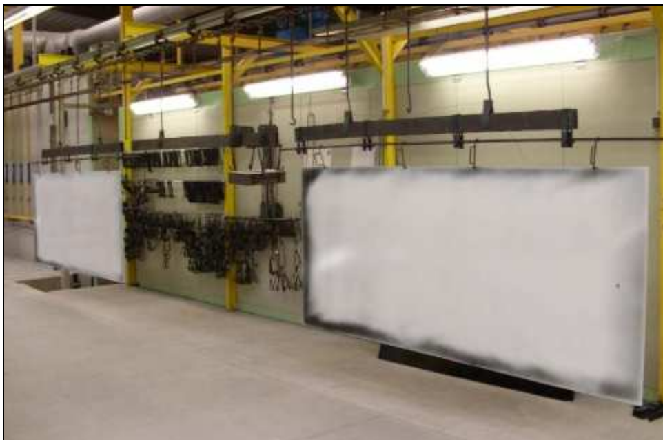
Abbildung 16: Versuchsaufbau zur Bestimmung der Wärmeverteilung in Brennofen (eigene Darstellung)
