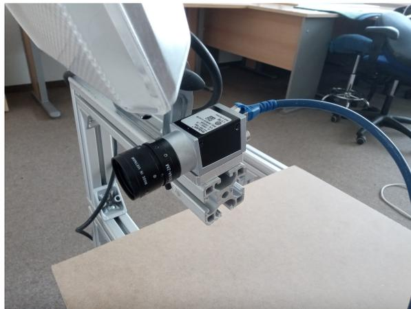
*Abbildung 3.4: Befestigung der Kamera am Gestell des Versuchsaufbaus.*
