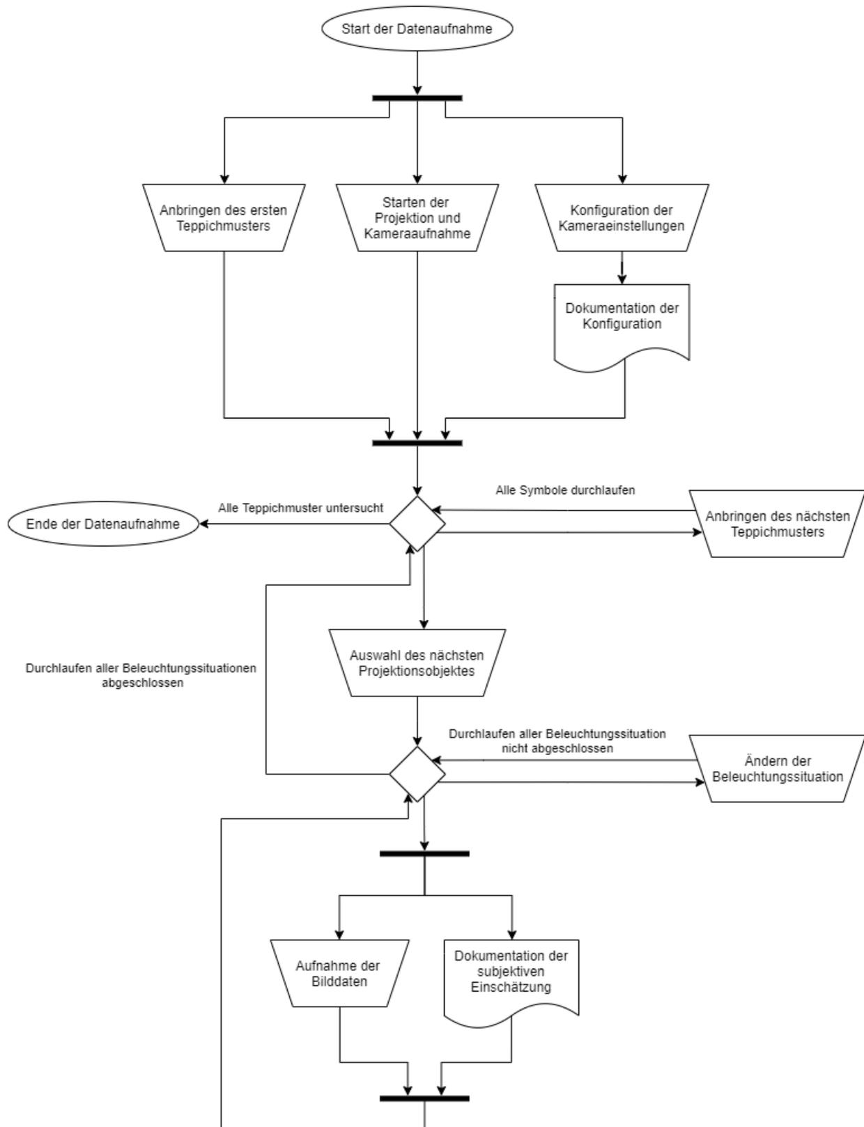
Abbildung 3.9: Ablaufdiagramm der Methodik für die Datenaufnahme. Methodik wurde für jeden der drei Projektoren separat durchgeführt.
