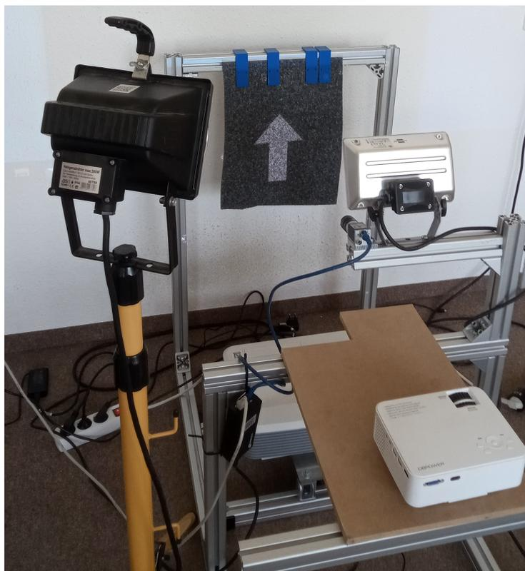
*Abbildung 3.6: Platzierung und Ausrichtung der Strahler, zur Simulation verschiedener Beleuchtungsbedingungen, im Versuchsaufbau. Links Halogenstrahler H05RN und Rechts LED-Strahler ML2705.*
